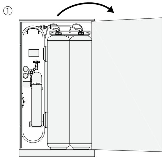
②加圧用ガス容器の起動ハンドルを左方向に止まるまで回転させ、全開にしてください。(窒素ガスが、加圧用ガス容器から消火剤容器に流れ込みます。)
